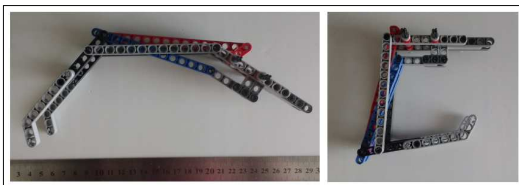
Figura 30 – Dedo 3 desenvolvido em LEGO
