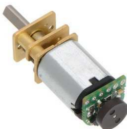
Figura 14 – Montagem do encoder no micromotor Pololu [11]
