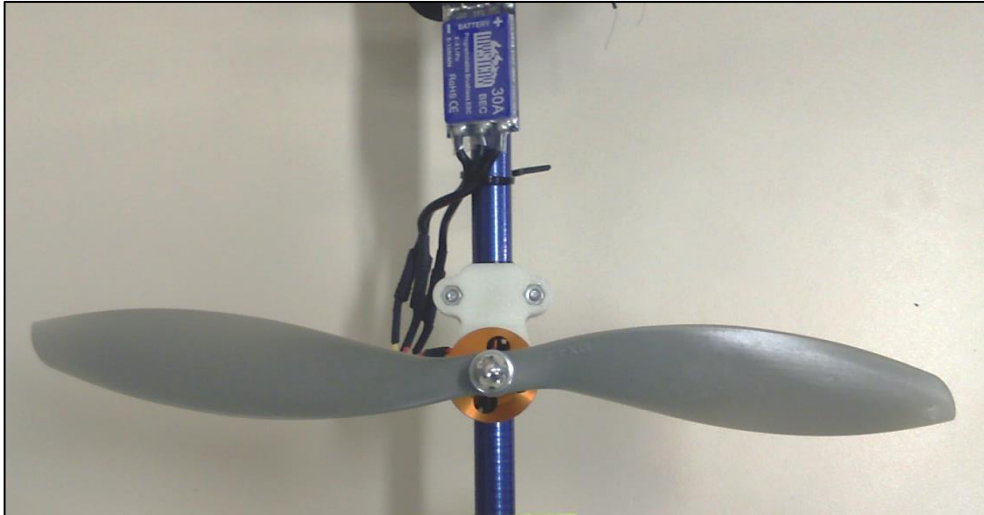
Figura 8 – Conjunto de Hélice – Motor – Esc (vista superior)
