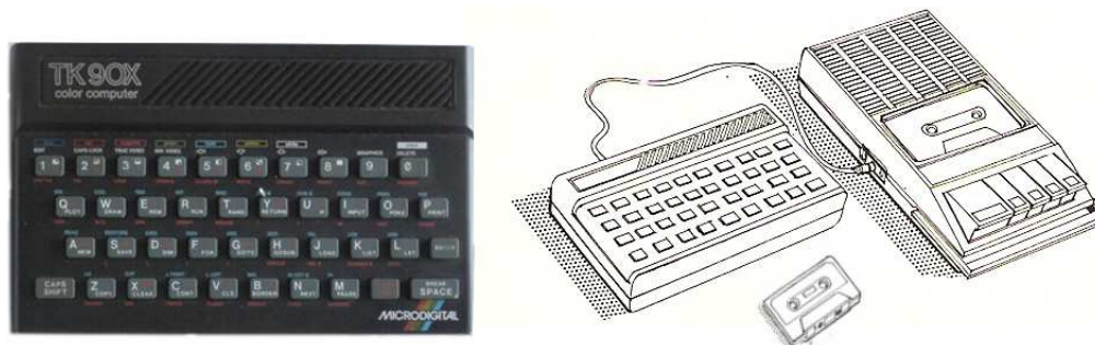
Figura 1: O aplicativo FUNÇÕES foi programado em uma unidade de processamento TK-90X com 48 Kbytes de memória que, acoplada a uma televisão, utilizava como unidade de leitura um gravador de fita cassete. Na imagem, uma fotografia do computador utilizado nas minhas experiências e um dos muitos esquemas pictóricos contidos em seu manual de operação.
